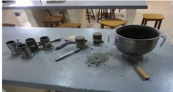
Figura 5: Moldagem de corpo de prova
