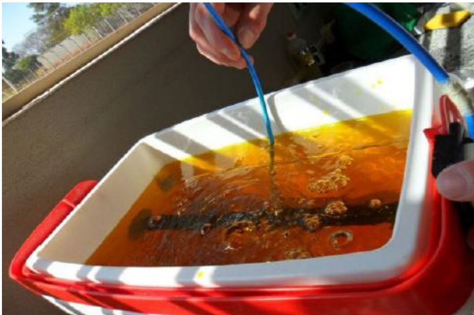
Figura 5: Caixa térmica já com os sistemas elétricos instalados (reator), com a presença de efluentes a serem tratados.
