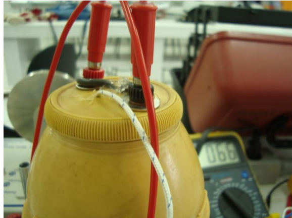
Figura 2: Parte superior do calorímetro construído.
