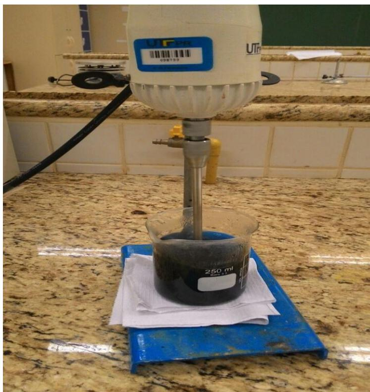
**Figura 8:** Foto retirada durante o processo de agitação mecânica realizado para o recobrimento das MNPs de  $\text{Fe}_3\text{O}_4$ .
