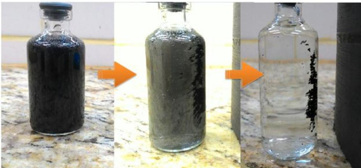
**Figura 10:** Foto retirada das nanopartículas de  $\text{Co}_3\text{O}_4$  frente a um campo magnético de neodímio.
