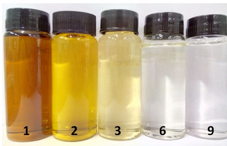
Figura 14. Variação na coloração das amostras após etapas de pré-purificação e purificação com as resinas de troca iônica. (1) glicerina bruta; (2) glicerina pré-purificada com Tanfloc; (3) Glicerina tratada com a resina catiônica 1:3; (6) glicerina tratada com a resina catiônica 1:3 e aniônica 1:3; (9) glicerina tratada com a resina catiônica 1:3 e aniônica 1:3 duas vezes.
