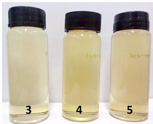
Figura 13. Variação de coloração entre as amostras de glicerina tratadas com as resinas cationicas (amostras 3, 4 e 5).
