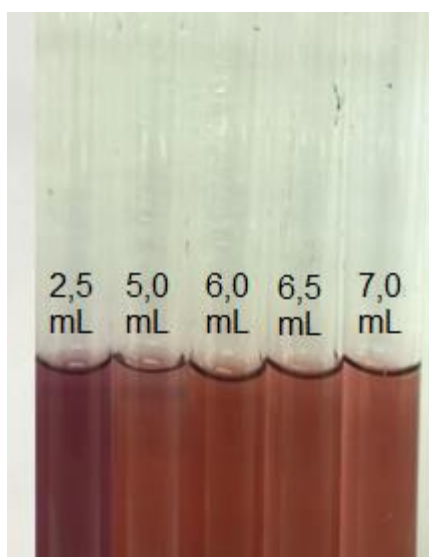
Figura 5 - Escala de cores produzidas a partir das soluções de AuNPs. Do menor para maior volume de solução de citrato de sódio 1% (m/v) vai da esquerda para direita
