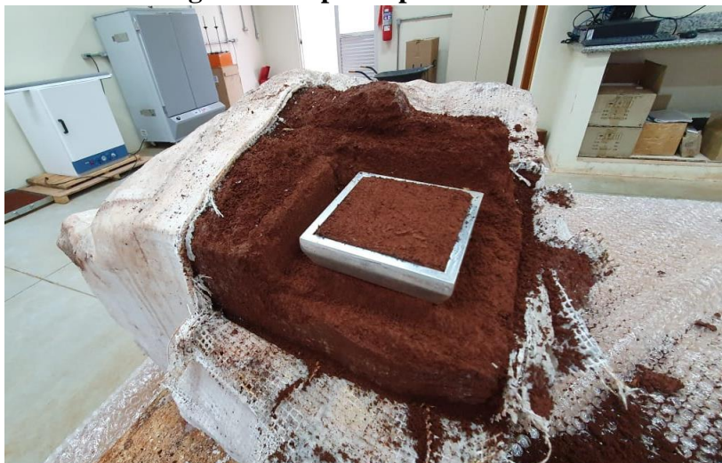
Figura 3.6 - Moldagem de corpo-de-prova de amostra indeformada
