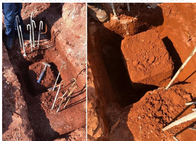
Figura 3.4 Coleta de bloco de amostra indeformada – Ponto D
