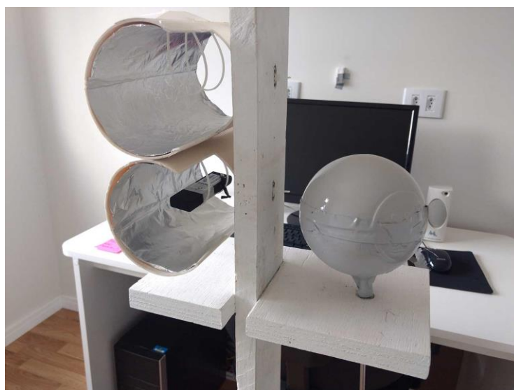
Figura 19 - TagTemp Stick a 1,10m de altura e termômetro de globo presos ao suporte de sensores
