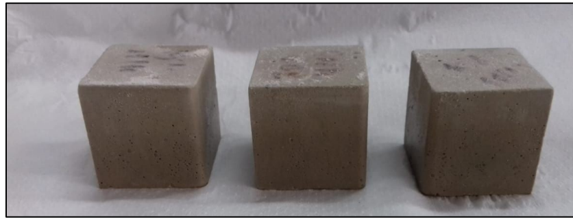
Figura 26 - Corpos de provas cúbicos de CSS + MK com 90 dias. Fonte: Autor.
