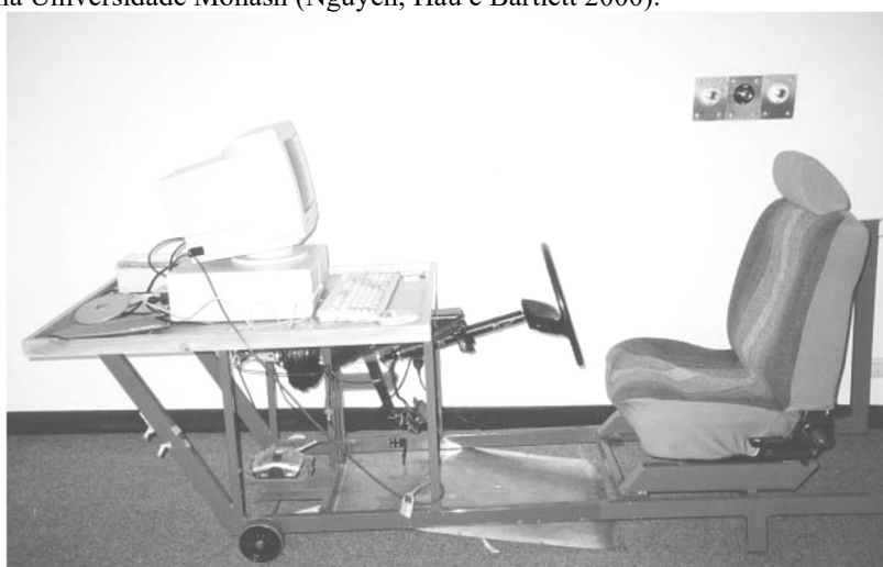
Figura 11 – Simulador de automóvel para monitoração de tempo de reação para frenagem desenvolvido na Universidade Monash (Nguyen, Hau e Bartlett 2000).
