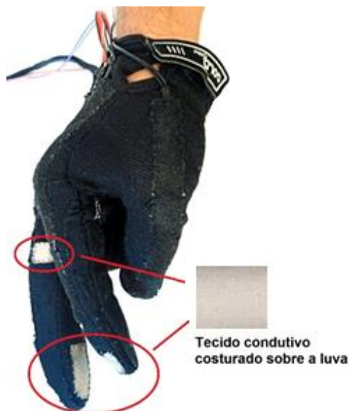
Figura 19 – Sensores de contato feito de tecido condutivo costurado sobre a luva.
