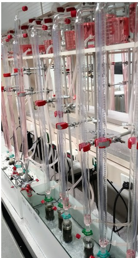
Fotografia 5: Tubos eudiômetros utilizados para coleta do biogás
