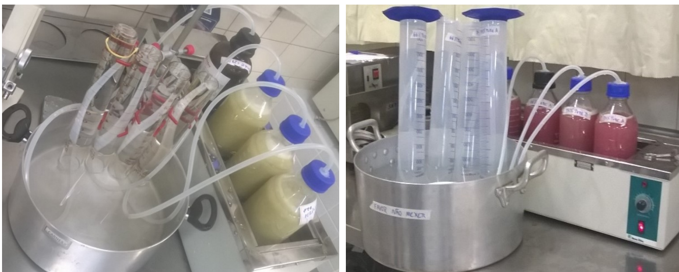
Fotografia 2: Sistema montado para os primeiros testes, à esquerda em provetas de 250 ml e à direita em provetas de 1000 ml
