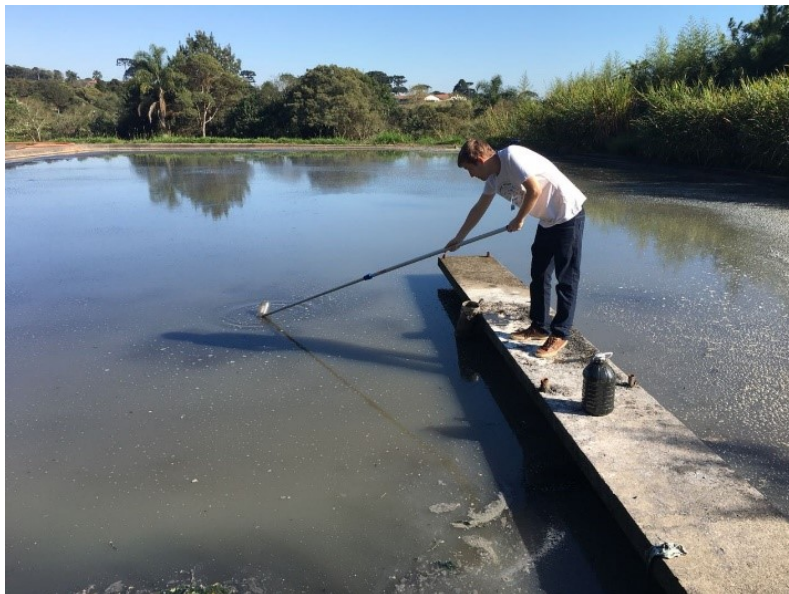
Fotografia 1: Coleta de lodo em lagoa anaeróbia para ser utilizado com inóculo
