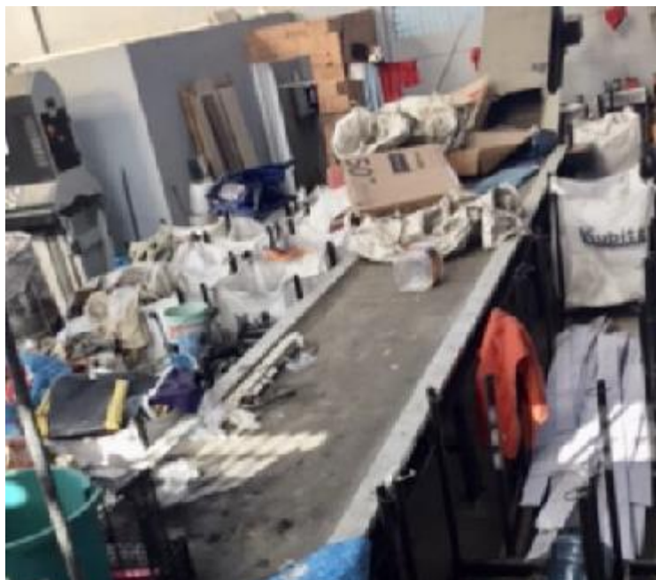
Figura 8 - Esteira de triagem do barracão da AMAGEM
