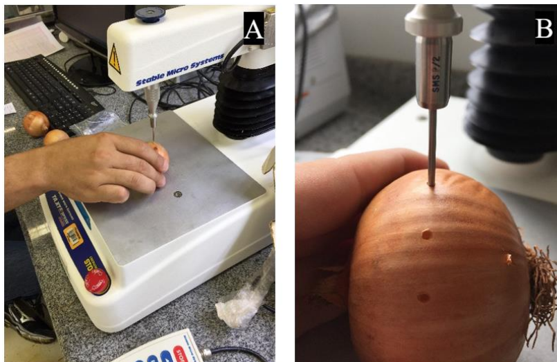
Figura 15 - Determinação da resistência à penetração da casca de cebola com o uso do equipamento texturômetro modelo TA.XT Express Enhanced® (A) e pontos de coleta de dados (B). UTFPR, Pato Branco – PR, 2020.
