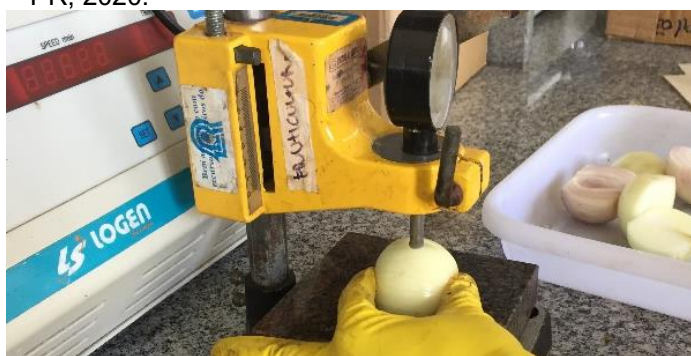
Figura 16 - Determinação de firmeza em bulbo de cebola com auxílio de penetrômetro de bancada. UTFPR, Pato Branco – PR, 2020.
