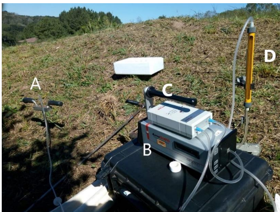
Figura 16 - Arranjo para medida de solo. A) sonda inserida à 95 cm de profundidade; B) equipamento AlphaGuard; C) Bomba; D) Rotâmetro
