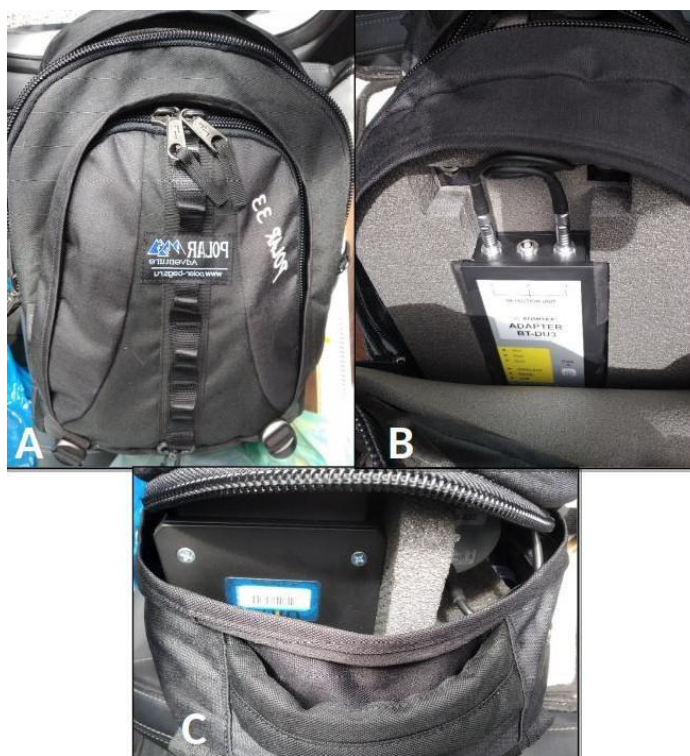
Figura 11 – Espectrômetro gama portátil pertencente ao DACOC/ UTFPR. A) mochila para transporte do equipamento; B e C) detectores
