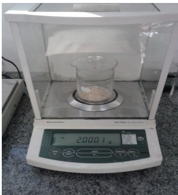
Figura 11 - Balança analítica de precisão Shimadzu Aux Fonte: Aatoria própria.
