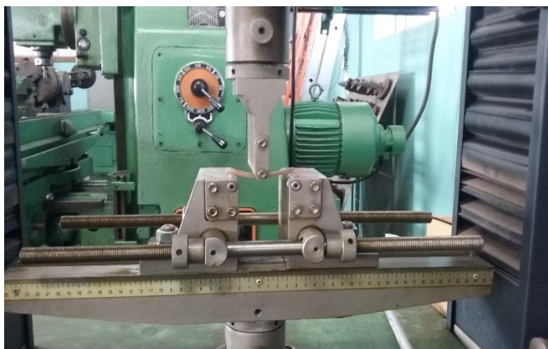
Figura 18 - Máquina universal ensaio de flexão Time Group Inc Fonte: Autoria própria.
