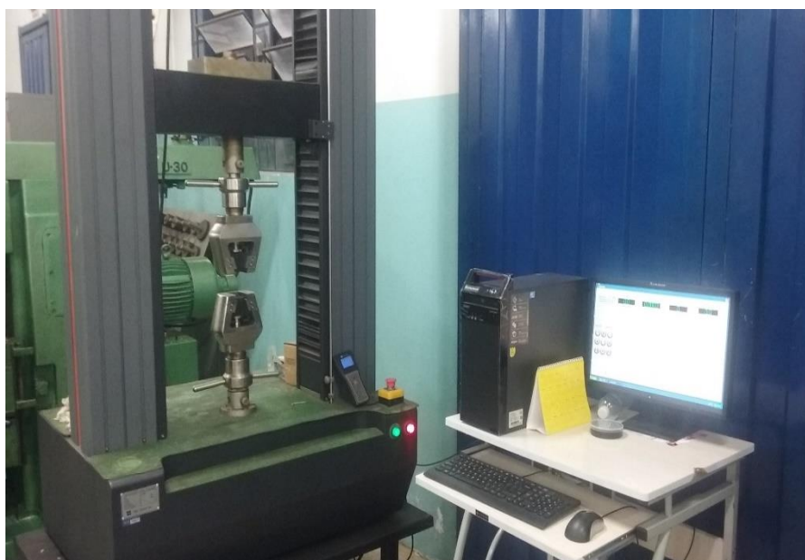
Figura 15 - Máquina universal ensaio de tração Time Group Inc Fonte: Autoria própria.
