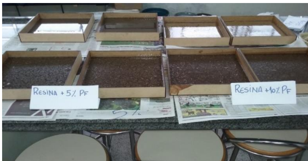
Figura 25 - Corpos de prova de ensaios térmicos
