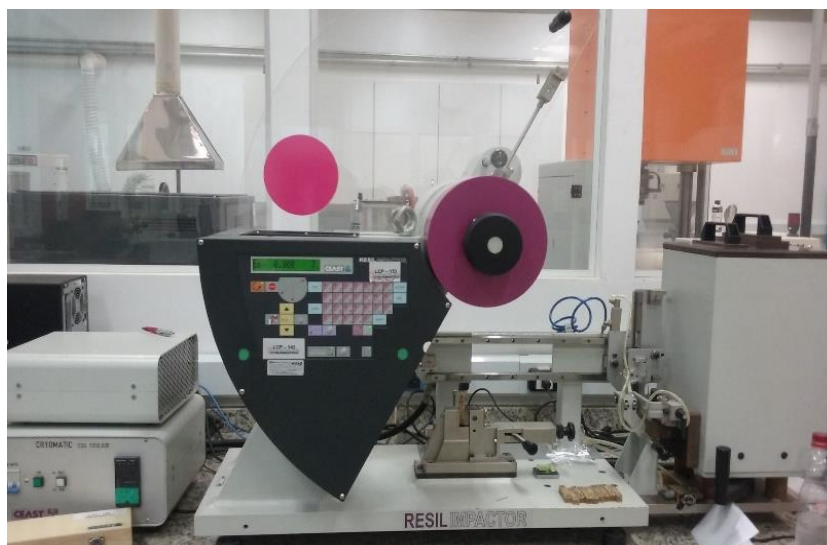
Figura 21 - Máquina de ensaio de impacto – modelo Impactor Ceast
