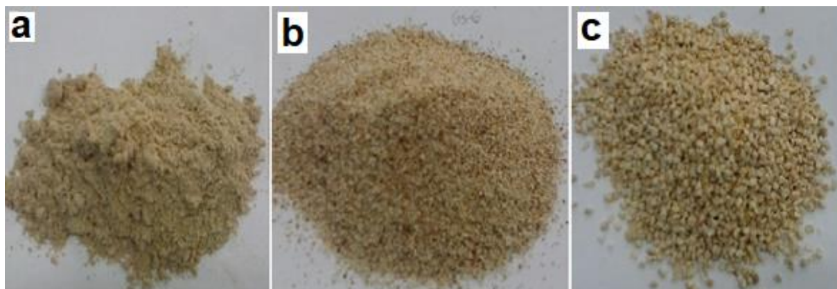
Figura 10 - Partícula fina 44 \mu\text{m} (a) partícula média 850 \mu\text{m} (b) partícula grande 2360 \mu\text{m} (c) Fonte: Autoria própria.
