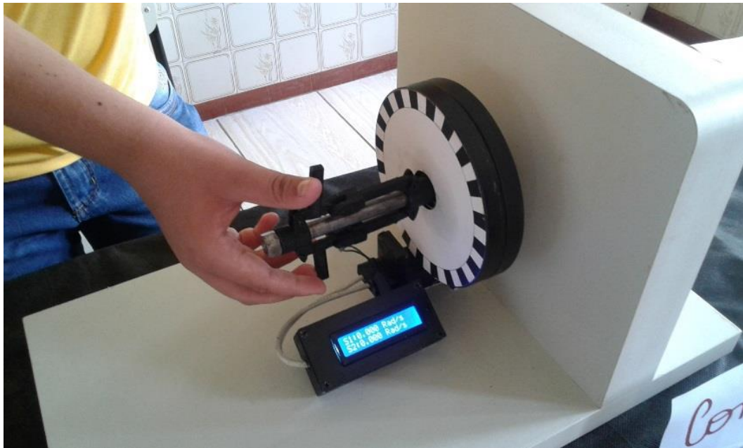
Figura 11: Alunos observando a leitura da velocidade angular dos discos.
