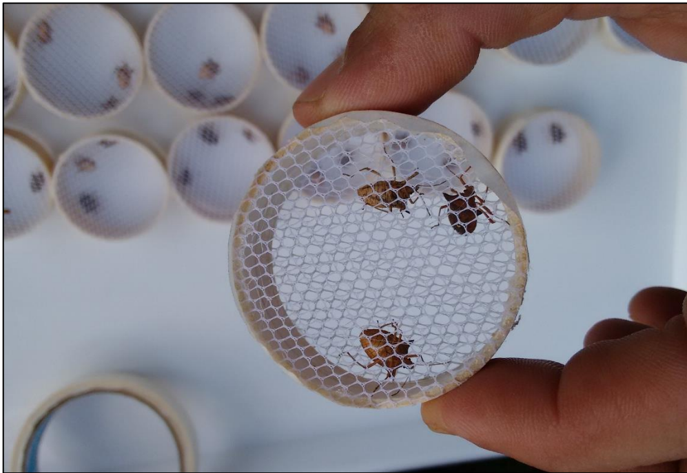
Figura 4. Clip-cage confeccionado a partir de cano de PVC de 40 mm e tecido filó, com adultos de Euschistus heros .
