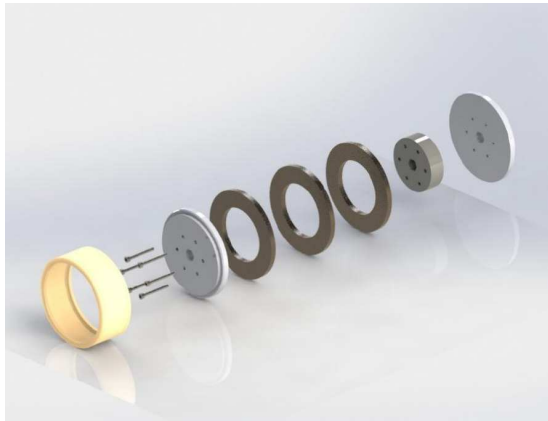
(a) Diagrama explodido da roda magnética do robô CRAS, mostrando os anéis magnéticos, o núcleo e discos de ferro, parafusos e revestimento.
