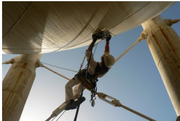
Figura 7 – Aplicação manual de END por ultrassom em um tanque de armazenamento de derivados de petróleo.
