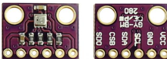
Figura 5 – Sensor BME280 utilizado para medição de pressão, umidade e temperatura
