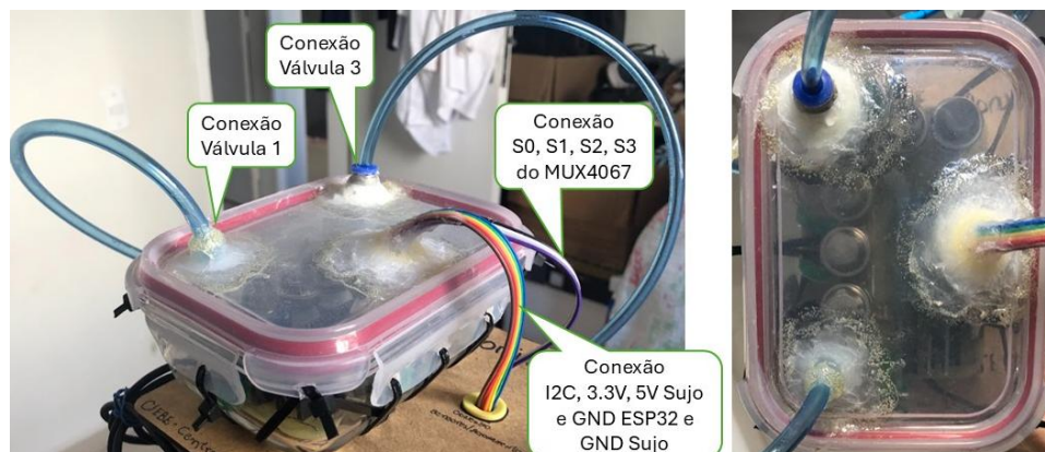
Figura 18 – Vista da câmara montada com as conexões para passagem da amostra e as passagens elétricas do sistema
