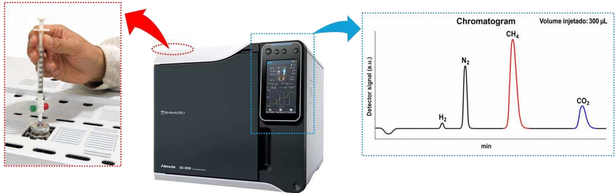
Figura 25b – Cromatógrafo gasoso utilizado como método de referência, procedimento de injeção manual de 300 µL de biogás com seringa adaptada para coleta de gás e exemplo de cromatograma gerado pelo equipamento.
