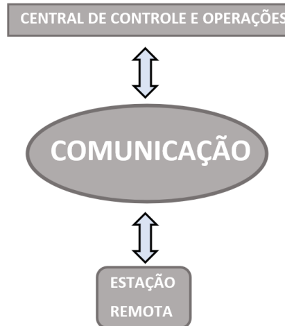
Figura 2 – Elementos de um sistema SCADA
