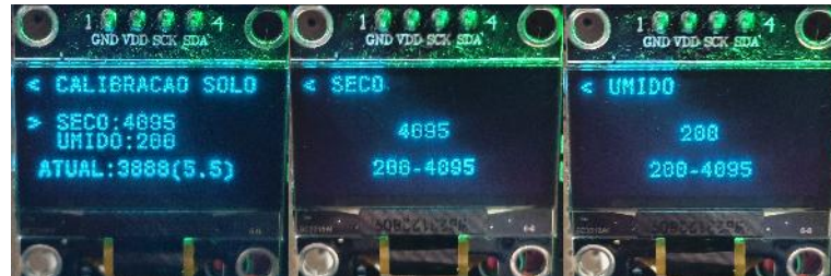
Figura 42 – Menu de calibração do sensor HD-38
