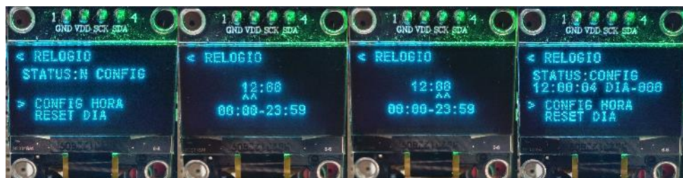
Figura 44 – Menu de configuração do RTC
