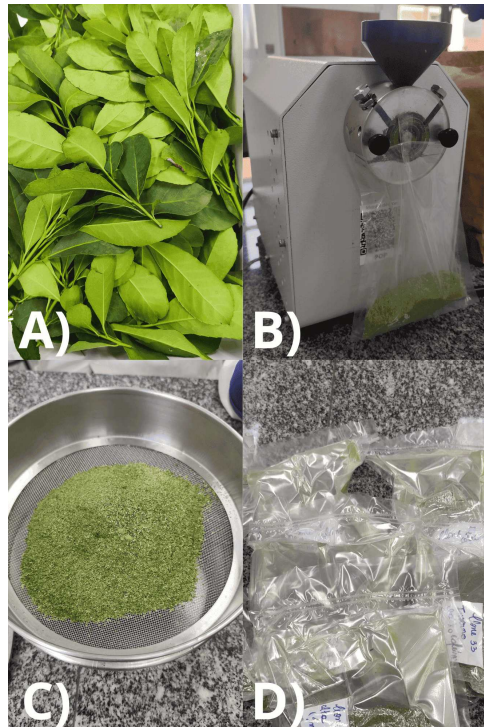
Figura 12 – Processamento das amostras: (A) Classificação; (B) Moagem da amostra seca; (C) Peneiramento; e (D) Acondicionamento em embalagem a vácuo.
