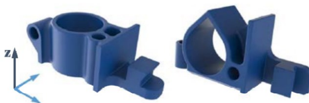
Figura 13. Impacto no projeto da peça após o estudo de orientação para AM
