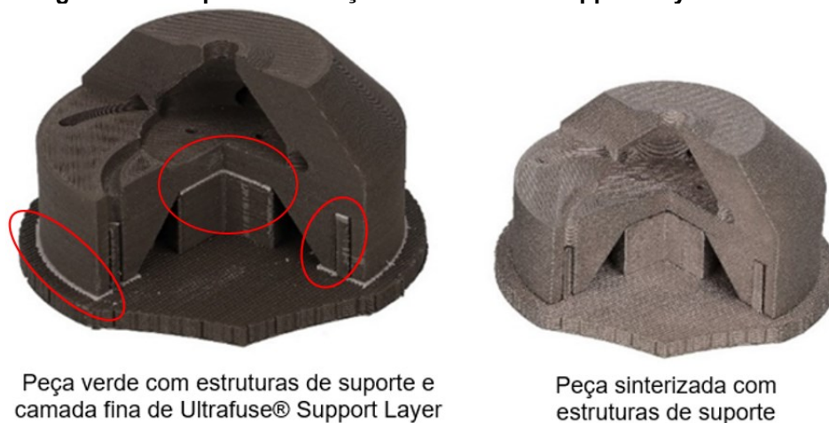
Figura 7. Exemplo de utilização do Ultrafuse® Support Layer da BASF
