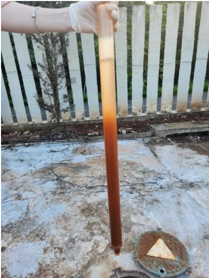
Fotografia 2 – Bailer com amostra de água retirada do poço de monitoramento PM 04
