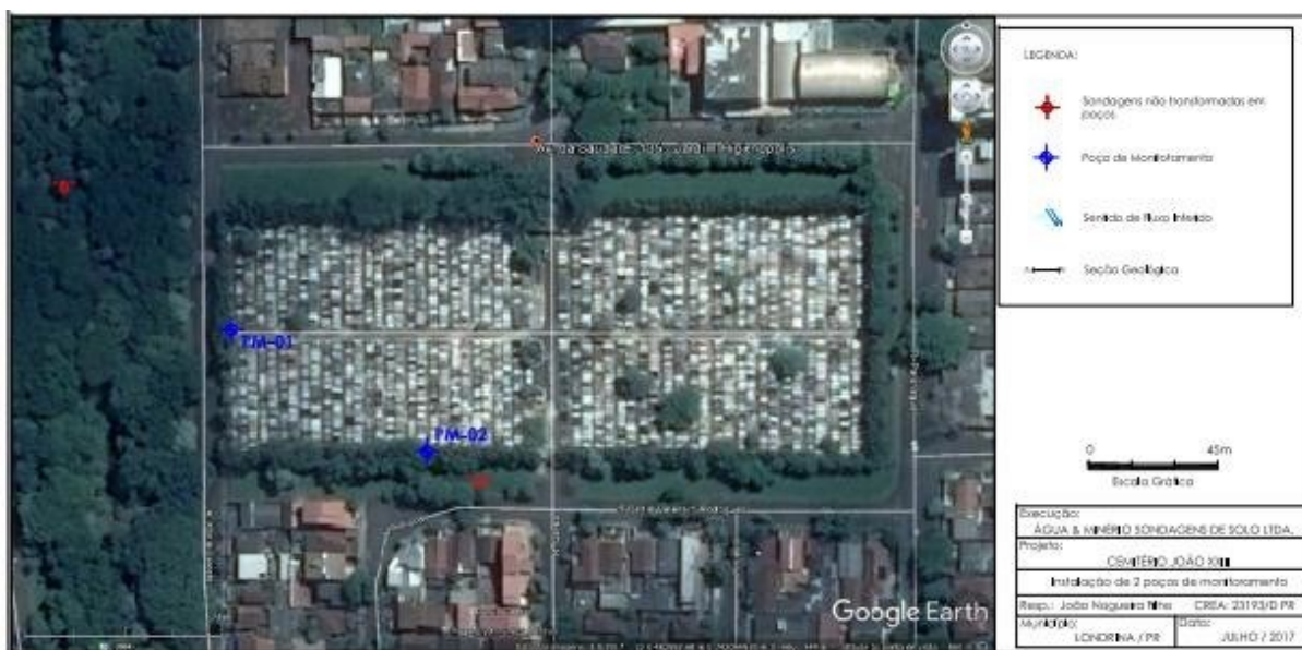
Figura 10 – Localização dos poços de monitoramento no Cemitério João XXIII
