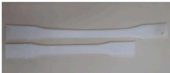
(b) Comparação entre corpo de prova pós e pré ensaio
