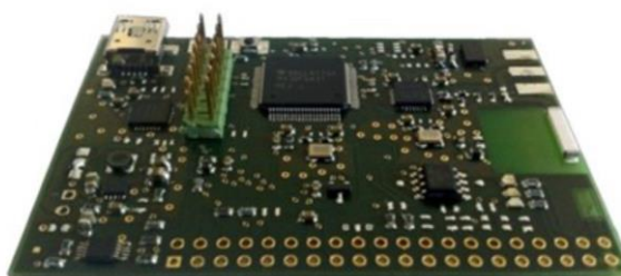
Figura 33 – Placa do dispositivo Wismote. Fonte: Arago Systems (2011, p. 1).
