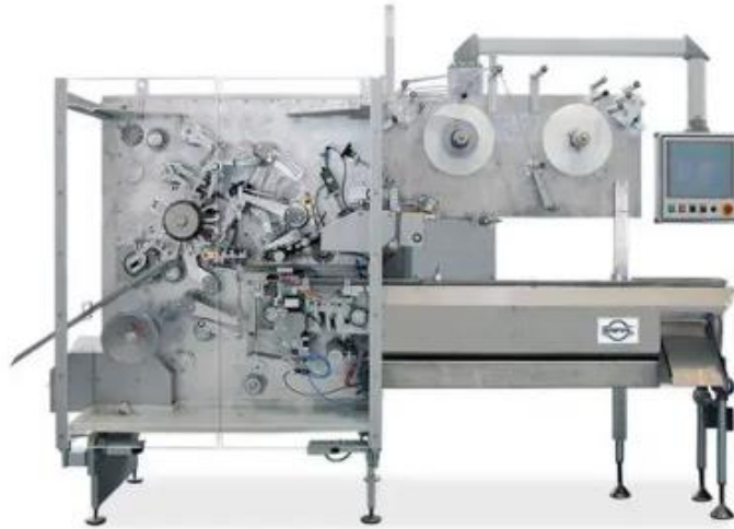
Figura 16 - Embaladora com dobras tipo envelope
