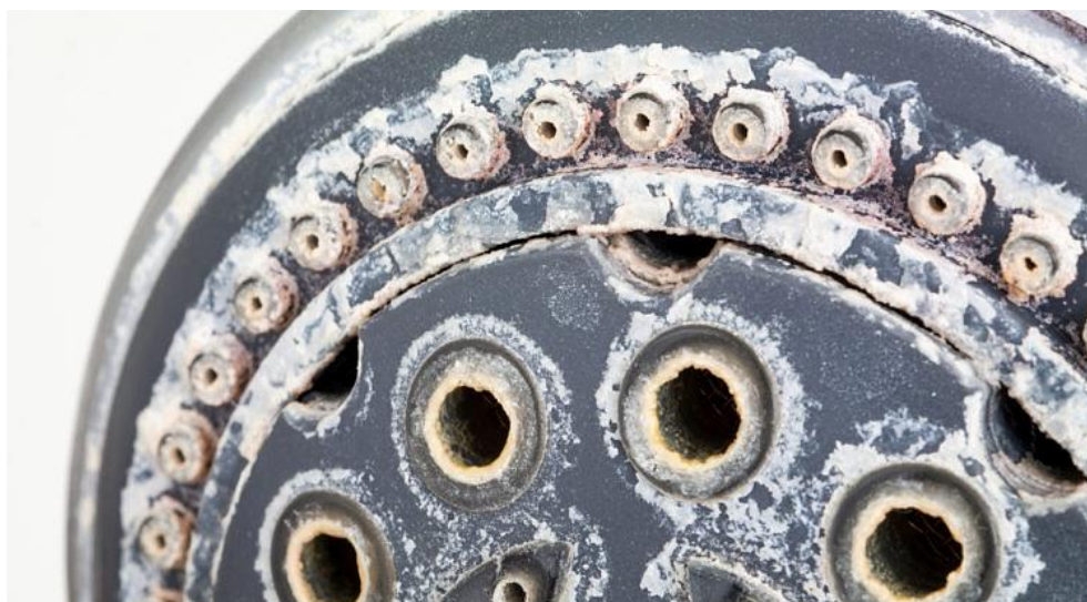
Figura 9 – Incrustações causada por sais de cálcio e magnésio.
