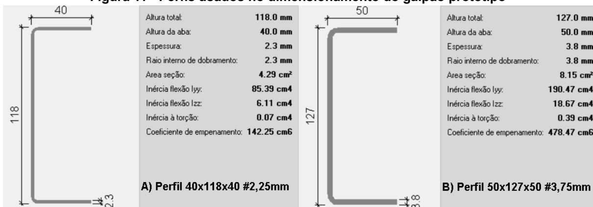
Figura 11 - Perfis usados no dimensionamento do galpão protótipo
