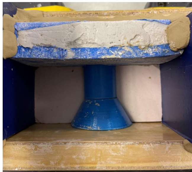
Figura 16 - Preparação da terceira parte do molde de gesso
