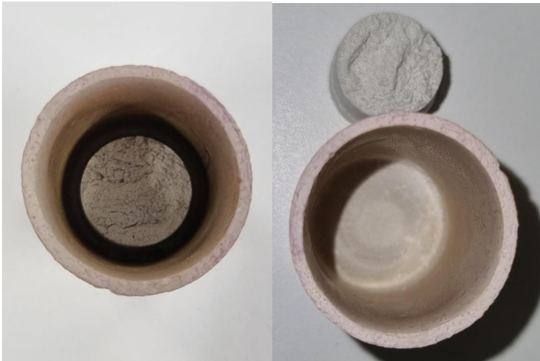
Figura 36 - Cadinho de óxido de estanho e amostra ensaiada após a termogravimetria
