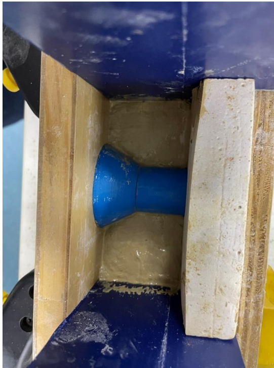
Figura 15 - Preparação da segunda parte do molde de gesso
