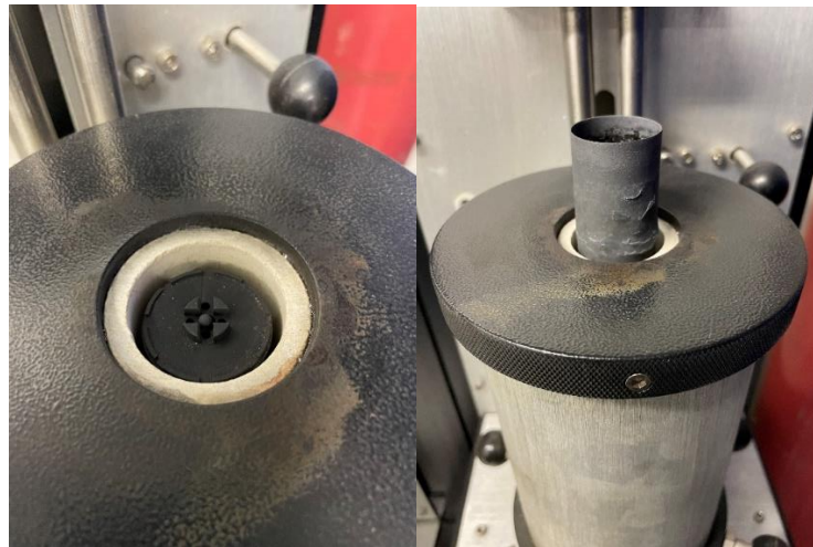
Figura 9 - Detalhe do encaixe do cadinho no equipamento de análises térmicas
