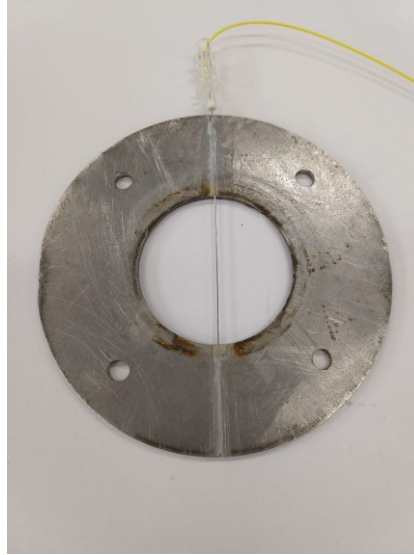
Figura 16 - Flange de aço com o capilar metálico fixado
