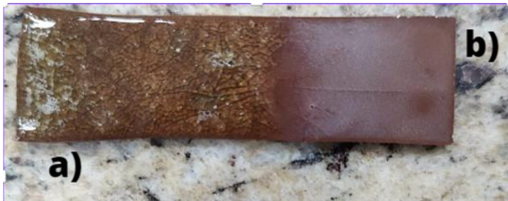
Figura 9 – Corpo de prova a) esmalte proposto e b) esmalte de referência queimado a 1200°C
