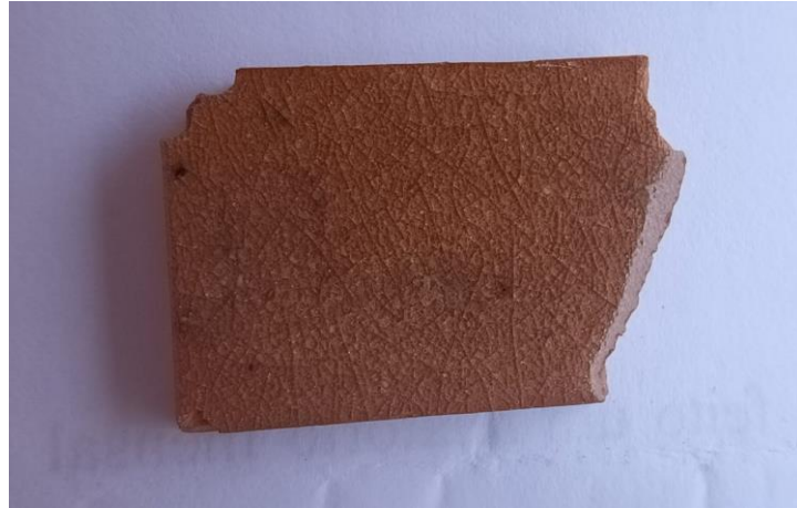
Figura 8 – Esmalte proposto queimado a 800°C
