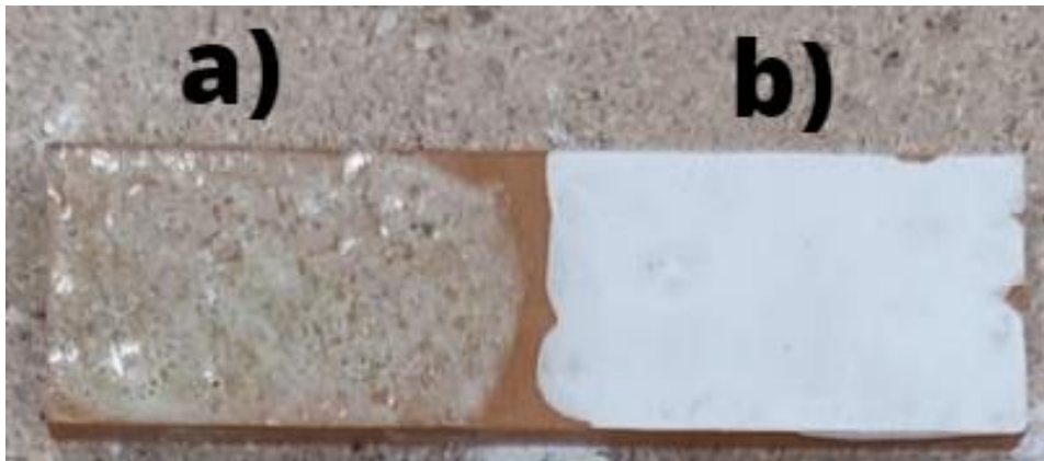
Figura 7 – Corpo de prova a) esmalte proposto e b) esmalte de referência queimado a 700°C
