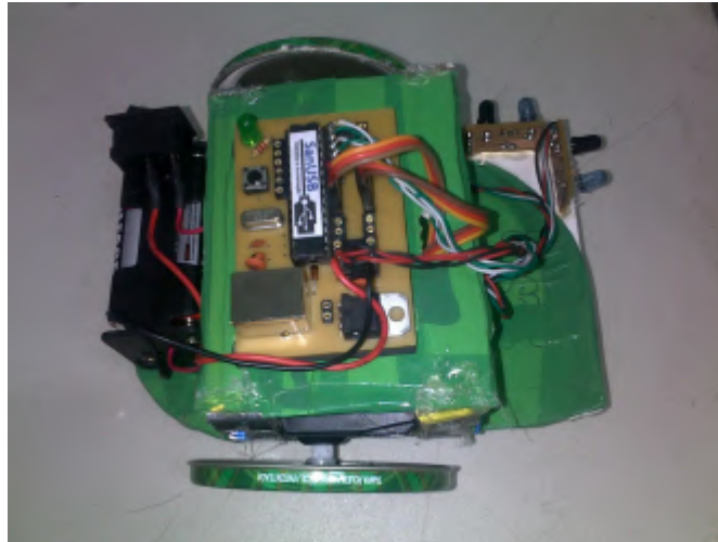
Fotografia 7 – Robô de baixo custo desenvolvido por alunos.
