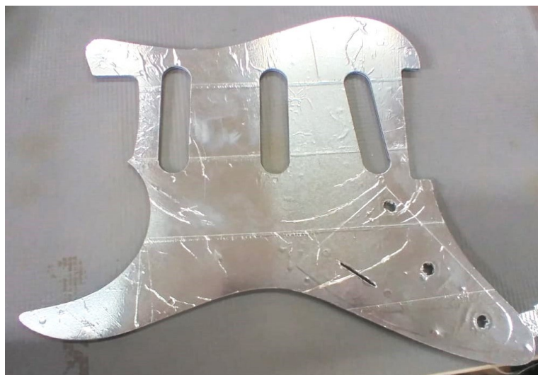
Figura 12 - Aplicação da fita de alumínio na tampa superior da guitarra.
