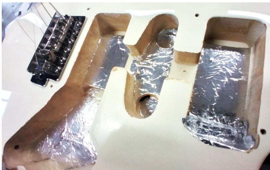
Figura 10 - Superfície lixada e início da aplicação da fita de alumínio.
