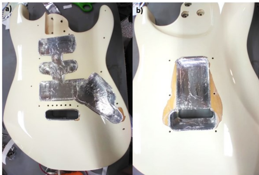
Figura 11 - Fita de alumínio aplicada por toda a superfície da cavidade interna da guitarra.
