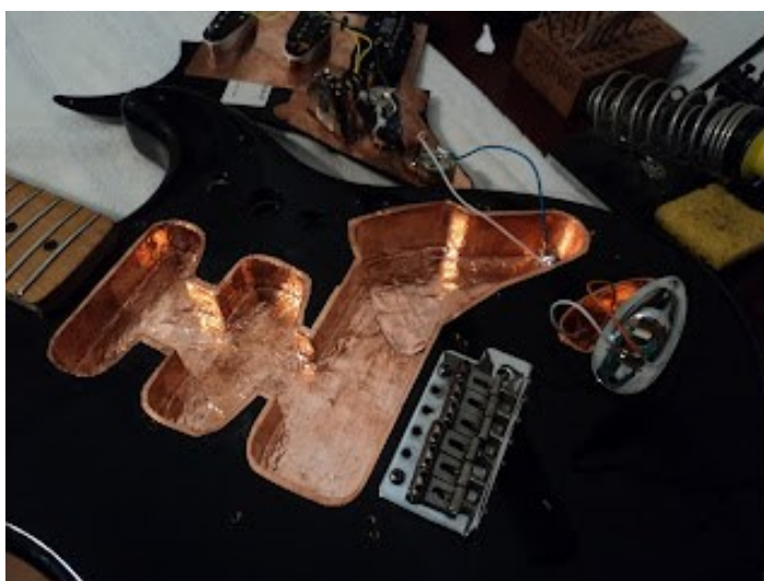
Figura 6 - Blindagem de guitarra utilizando fita de cobre.
