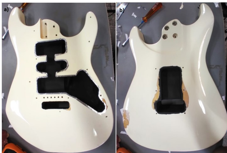
Figura 14 - Tinta condutiva aplicada por toda a superfície da cavidade interna da guitarra.
