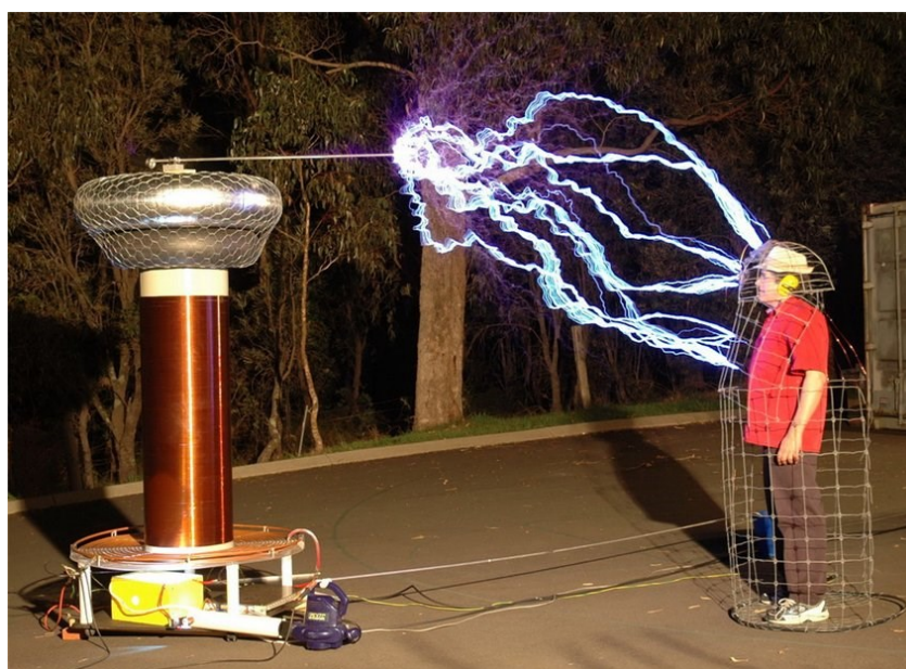
Figura 5 - Demonstração do funcionamento de uma Gaiola de Farada.
