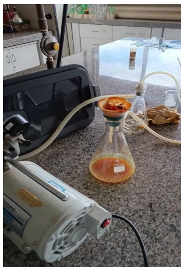
Figura 10 – Filtração a vácuo da reação
