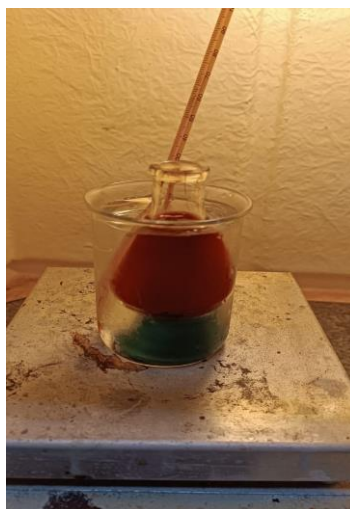
Figura 9 – Reação para a síntese da curcumina nitrada
