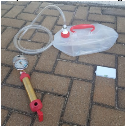
Figura 17 – Demais itens que compõem o kit do Permeâmetro Guelph – bomba de vácuo, recipiente portátil para armazenamento de água e nível bolha
