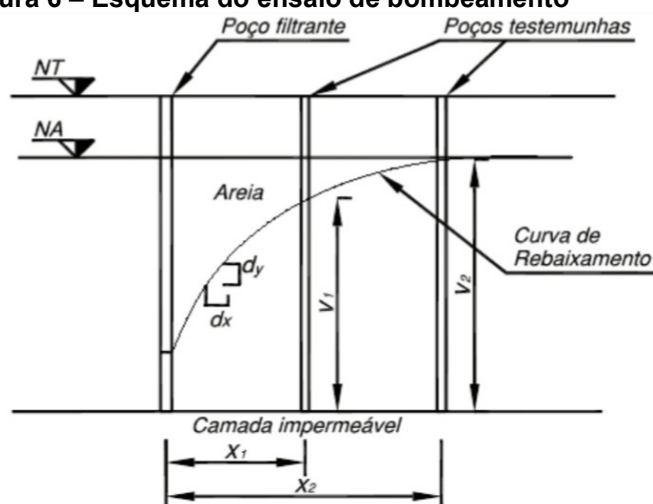
Figura 6 – Esquema do ensaio de bombeamento
