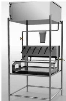
Figura 13 – Engarrafadora de 6 bicos.
