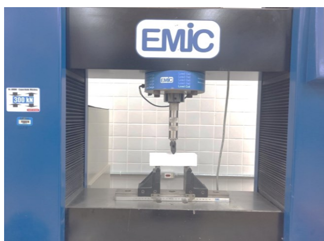
Fotografia 15 - Início do ensaio de flexão
