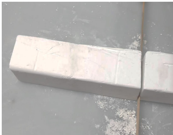
Fotografia 14 - Cortando os corpos de prova no comprimento de 160mm
