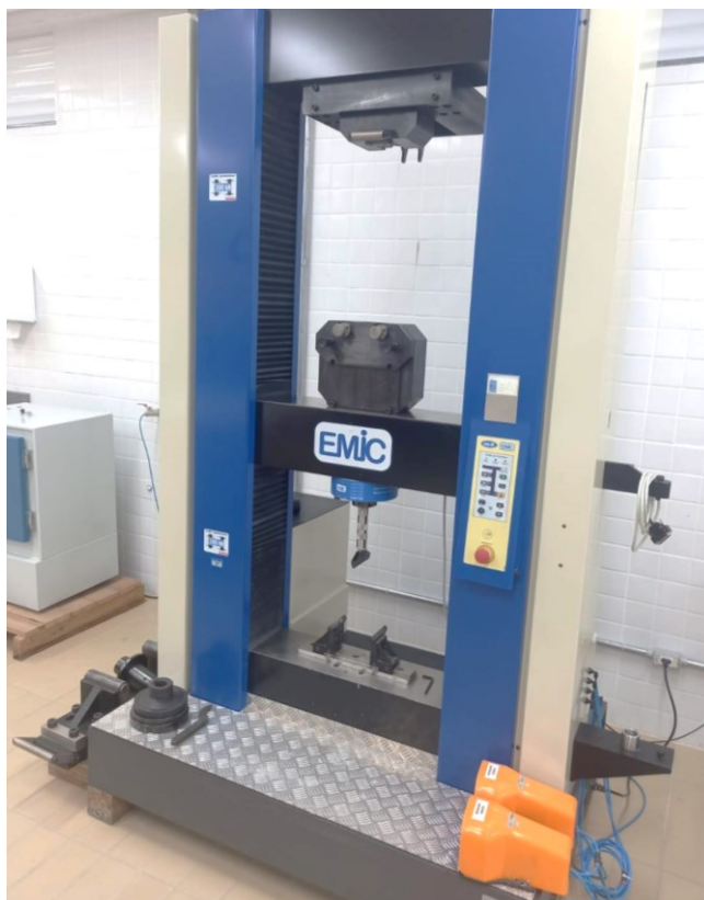
Fotografia 8 - Máquina de ensaio universal
