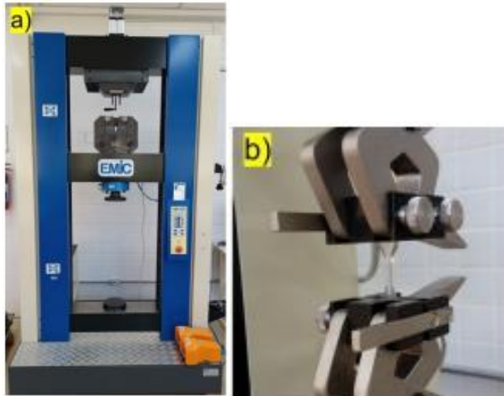
Figura 15 - Máquina Universal de Ensaios (a), acessórios para ensaio de tração (b)
