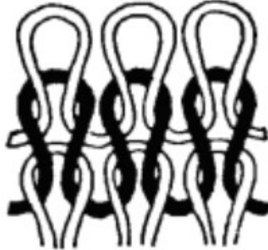
Figura 9 - Laçada malharia de trama (monofrontura)
