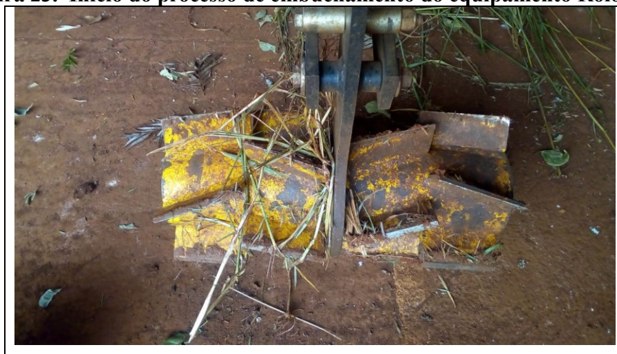
Figura 23. Início do processo de embuchamento do equipamento Rolo Max
