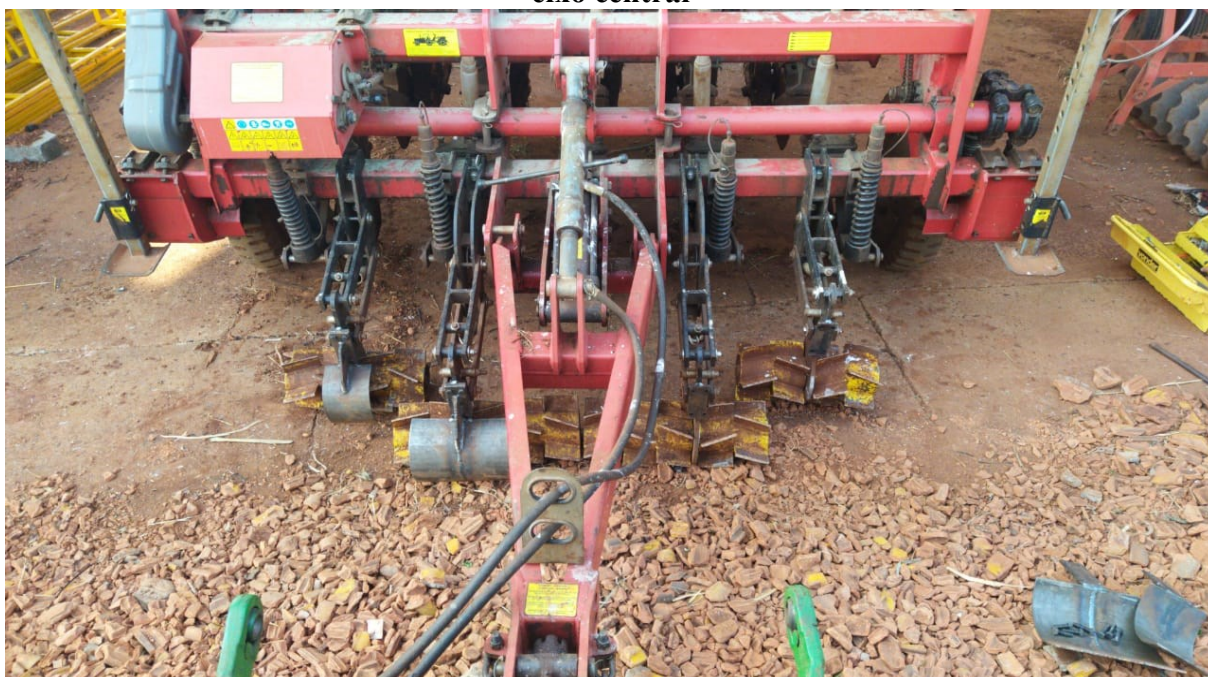
Figura 5. Semeadora com Rolo Max com e sem proteção contra o embuchamento no eixo central
