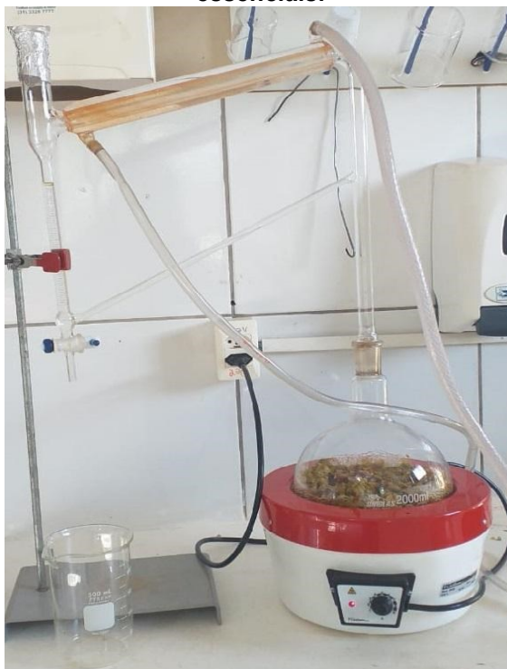
Figura 24 Aparelho clevenger utilizado para a obtenção do rendimento total dos óleos essenciais.
