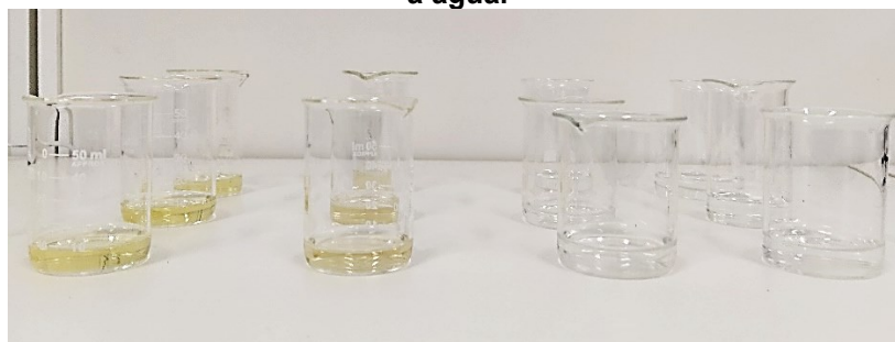
Figura 31 – Comparação da coloração observada após contato das amostras de PUCS14 (1ª e 2ª coluna de amostras), PUCS10 (3ª coluna de amostras) e PUCS7 (4ª coluna de amostras) com a água.
