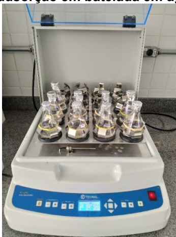
Figura 9 – Ensaio de adsorção em batelada em agitador orbital.
