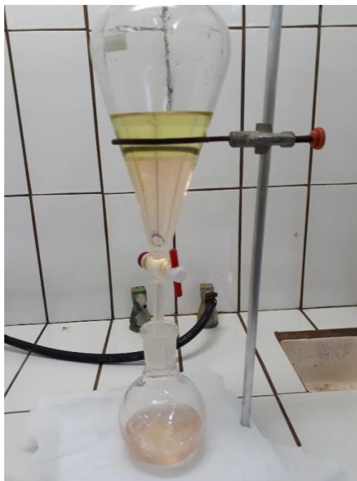
Figura 13. Funil de separação com quercetina acetilada
