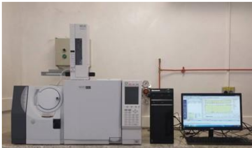
Figura 10. Cromatógrafo gasoso Varian 431/CP-3800 acoplado a um detector de massa Varian 210 íon trap MS
