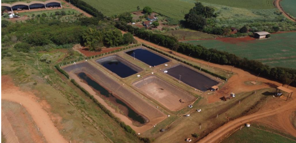
Figura 7 - Estruturas da CTR Maravilha. (a) Vista superior das lagoas de tratamento primário do lixiviado, onde, ao fundo se observa os galpões de compostagem; (b) Célula ativa; (c) Estação de queima de gás de uma célula finalizada
