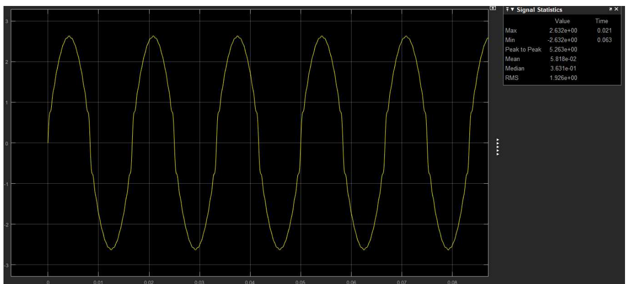
Figura 22 - Forma de onda da corrente sem filtragem do inversor de 3 kW
