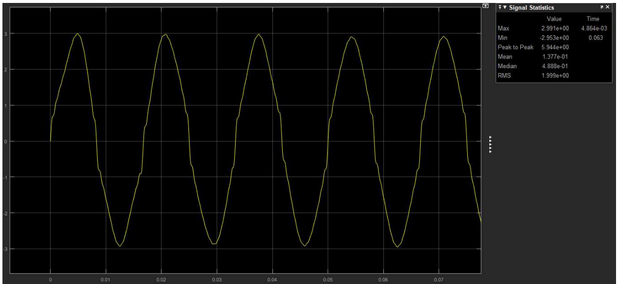
Figura 23 - Forma de onda da corrente após filtro de 3ª harmônica do inversor de 3 kW
