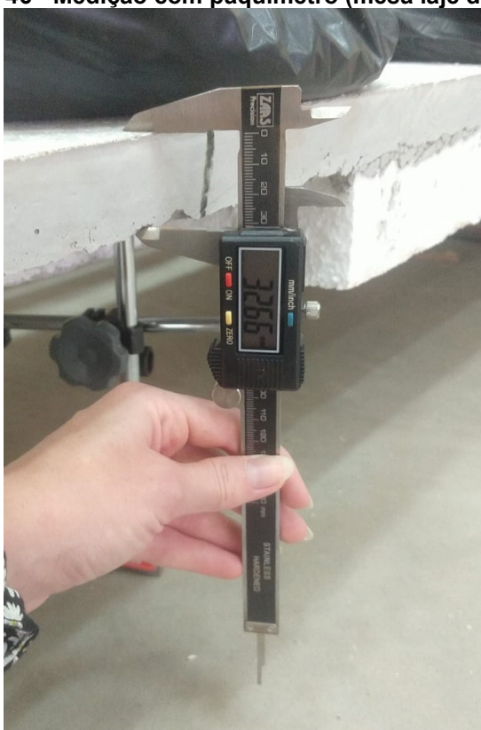
Figura 46 - Medição com paquímetro (mesa laje de CAA).
