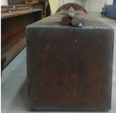
Figura 34 - Apoio rotulado para as lajes.
