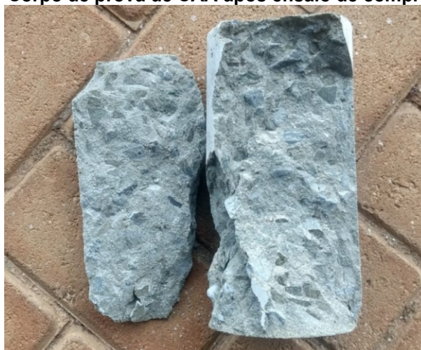
Figura 47 - Corpo de prova de CAA após ensaio de compressão axial.
