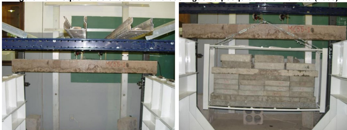
Figura 19 - Esquema de ensaio de uma das vigas da pesquisa de Simonette (2008).
