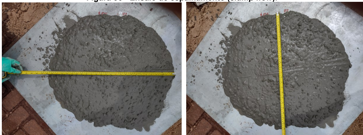
Figura 36 - Ensaio de espalhamento ( slump flow ).
