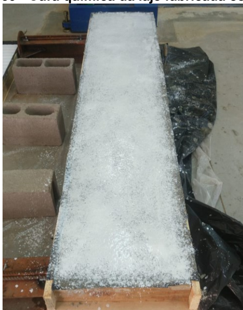
Figura 39 - Cura química da laje fabricada com CAA.
