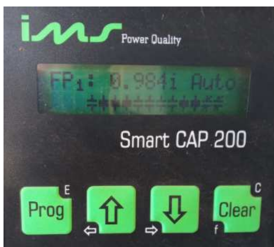
Figura 11- Parametrização do fator de potência Fonte: Acervo Pessoal (2021).
