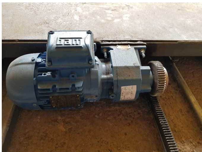
Figura 19 - Mecanismo do tipo pinhão-cremalheira utilizado no transporte das caçambas estacionárias
