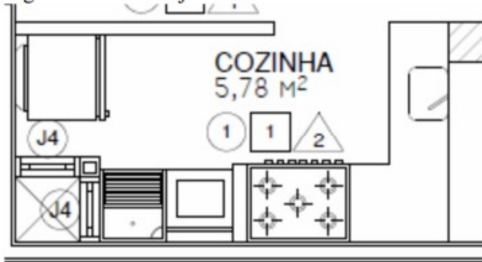
Figura 5: Falta de janelas na cozinha
